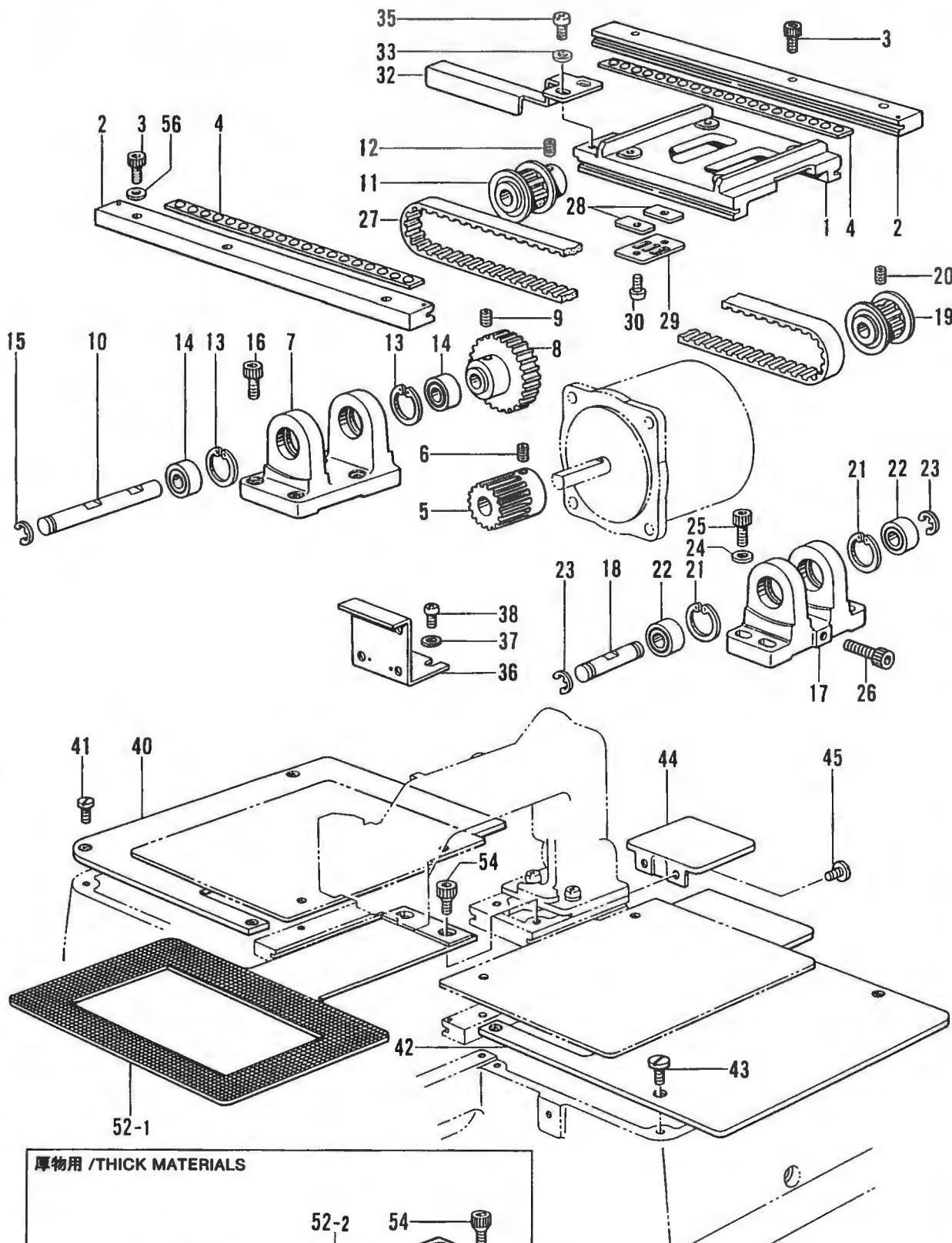
E. 駆動側・送り関係 / Feed guide mechanism / Transportführung /
